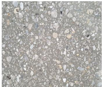
Необходимо помнить, что механическая подготовка основания применяется НЕ ТОЛЬКО для удаления загрязнений и открытия пор, но и для увеличения адгезии с покрытием. Чем более текстурированная поверхность получается в результате обработки, тем выше адгезия покрытия, и, следовательно, выше его стойкость к динамическим нагрузкам и дольше срок эксплуатации.
